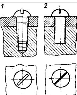
22. Какое изображение винтового соединения рекомендуется применять на сборочных чертежах?
